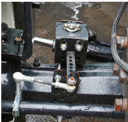
Reichardt rüstet seine automatischen Lenksysteme standardmäßig mit einem Lenkwinkelsensor aus.
