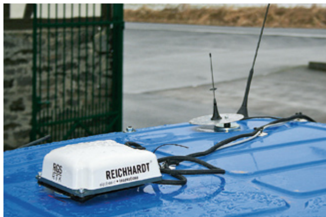
Für den Korrekturdatenempfang per GSM-Mobilfunk benötigt man zusätzlich zu dem GPS-Empfänger eine Funkantenne (linke kleine Stabantenne).
