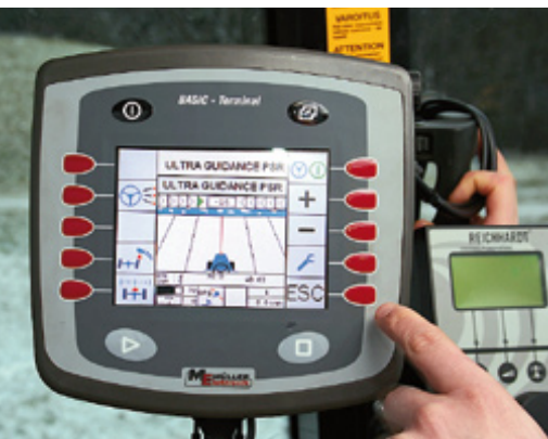
Die automatische Lenkung von Reichardt kann mit einem ISO-Bus-Terminal bedient werden. Standardmäßig gehört zum Lieferumfang der kleine Bediencomputer, die PSR cBox (rechts im Bild).
