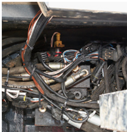
Das elektrohydraulische Proportionalventil für die Automatiklenkung hat Reichardt an dem New Holland TD 70 D nachgerüstet.
