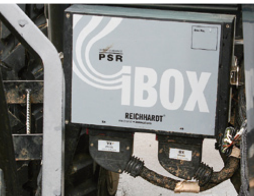
Der Steuerrechner für die Lenkung, die PSR iBox, war an unserem Testschlepper vorne rechts außen an der Kabine montiert.
